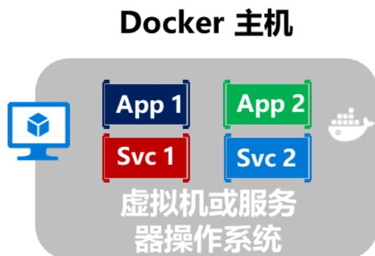
图 2-1. 运行在一个容器主机上的多个容器
