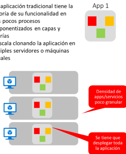
Figura 4-6. Despliegue monolítico versus el enfoque de microservicios
