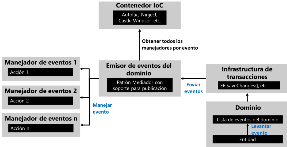
Figura 7-16. Canalizador de eventos del dominio usando IoC
