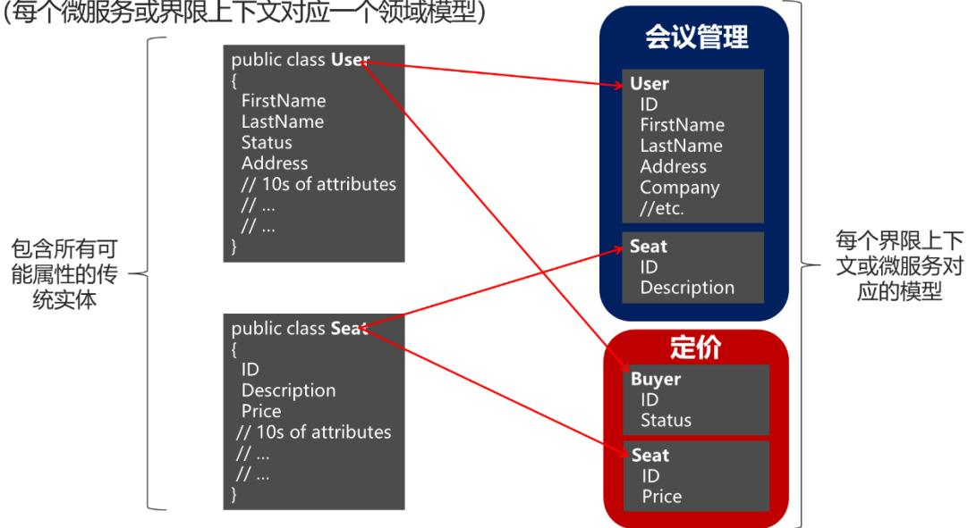
图 4-11. 传统数据模型分解成多个领域模型
