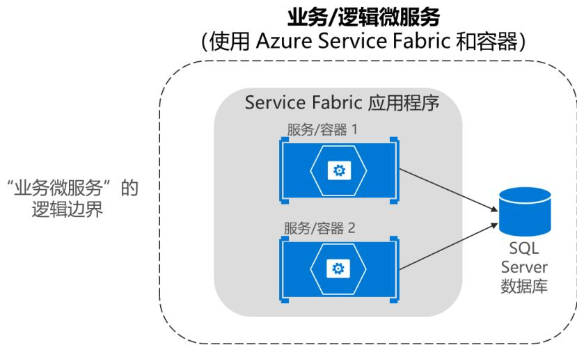
图 4-28. 在 Service Fabric 中使用多个服务（容器）的业务微服务
