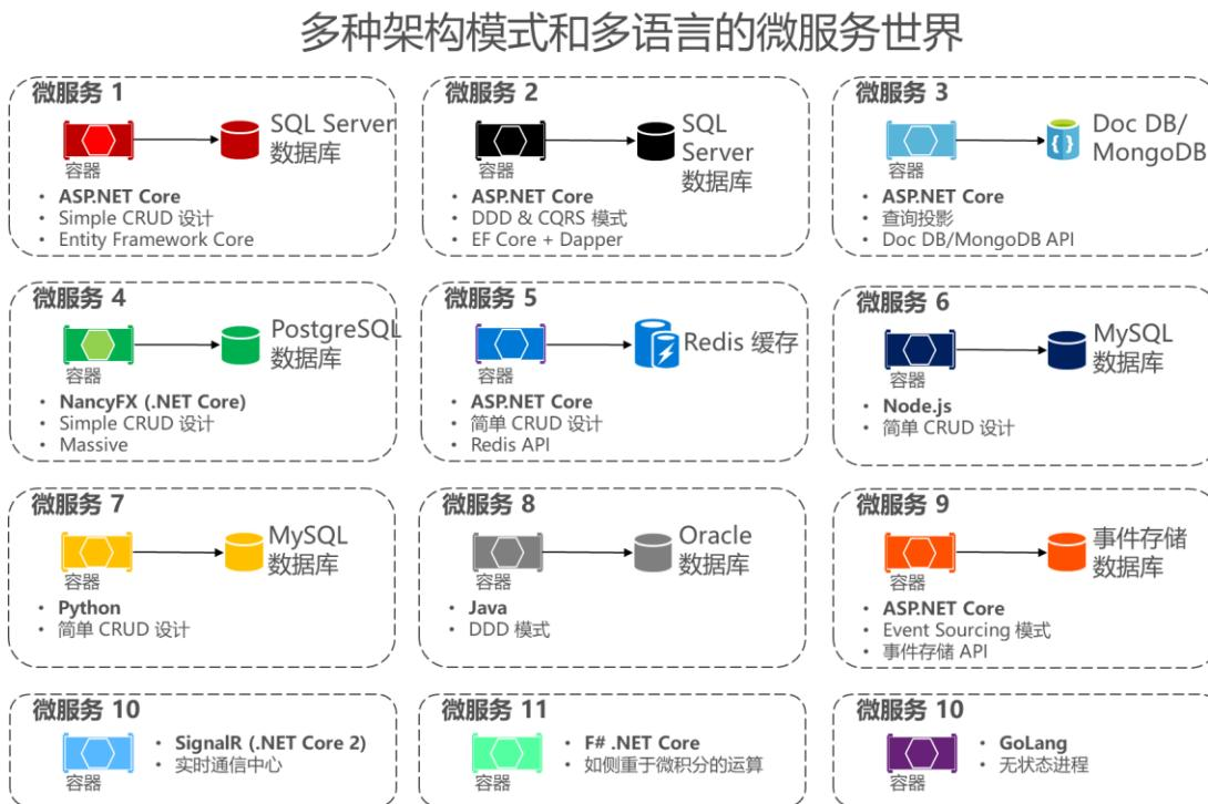
图 8-3. 多种架构模式和多语言的微服务世界
