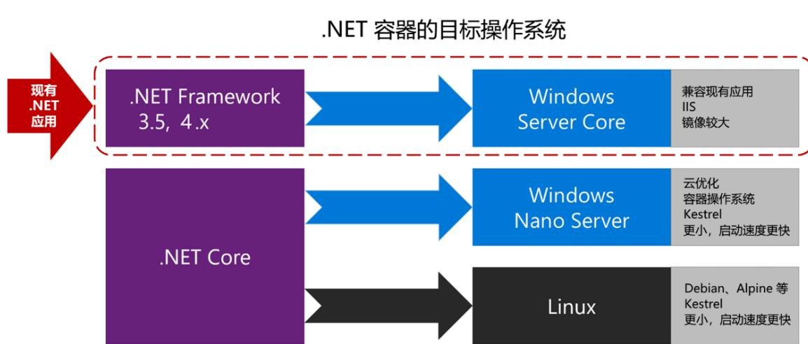
图 3-1. 根据.NET 框架的版本来选择操作系统
