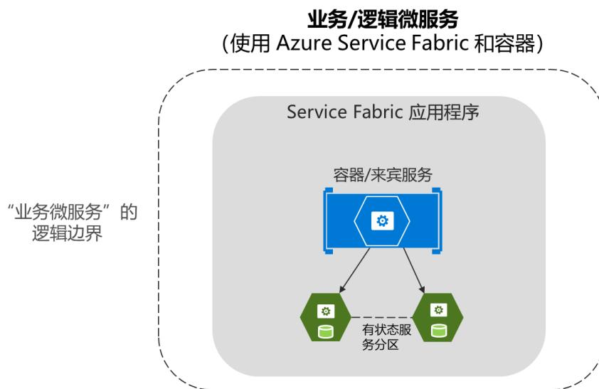
图 4-29. 使用容器和有状态服务映射到一个 Service Fabric 应用的业务微服务
