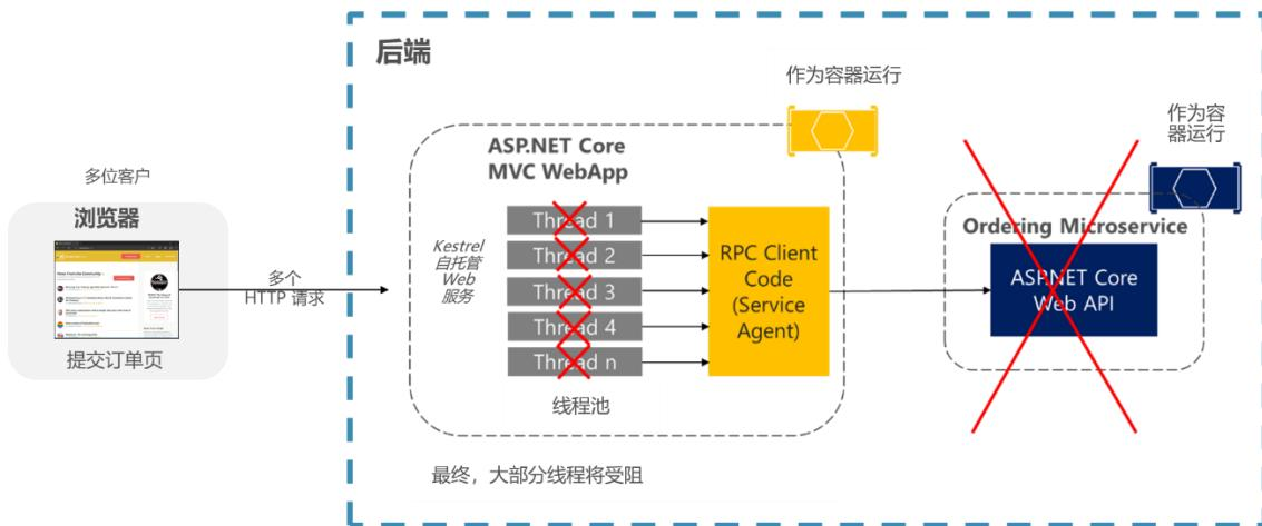
图 10-1. 由于影响服务线程可用性的依赖关系导致部分故障
