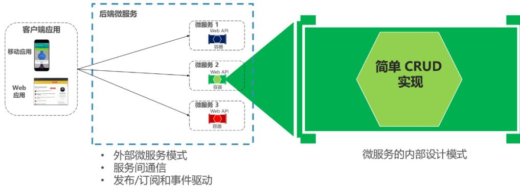
图 8-4. 简单的 CRUD 微服务的内部设计
