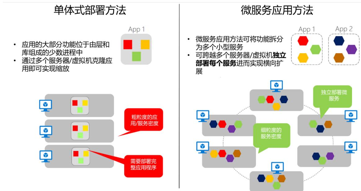
图 4-6. 单体式部署和微服务方式的对比
