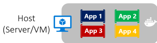
图4-2. 单体式方法：主机里运行了多个应用，每个应用以一个容器的方式运行
